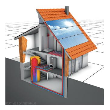
Die Wärme aus den thermischen Sonnenkollektoren wird direkt in den Bauteilen – Wände, Bodenplatte, Decke und in einem kleinen (1,5 m³) Pufferspeicher – gespeichert. Hygienische Warmwasserbereitung in einer Frischwasserstation. Die Nachheizung erfolgt mit Biomasse (Pellets oder Scheitholz im Keller oder Wohnraum). Zusätzlich kann eine PV-Anlage mit oder ohne Batterie den Haushaltsstrombedarf decken.
